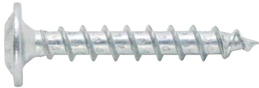
Die ASSY 3.0 SK mit großem Scheibenkopf und Vollgewinde ist speziell für die Verschraubung von Blechformteilen an Holzelemente z.B. Pfostenverschraubung.
