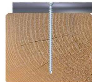
Charakteristische **Ausziehfähigkeit**  $F_{ax,Rk}$  von ASSYplus VG Holzbauschrauben mit erforderlicher Mindestschraubenlänge  $\ell_{Schraube}$
