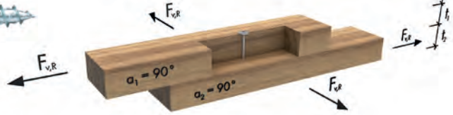
Schertragfähigkeit F_{v,Rk} bzw. F_{v,Rd} mit erforderlicher Mindestschraubenlänge \ell_{req}
