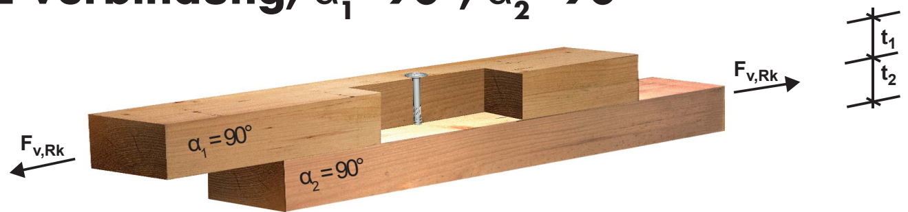
Schertragfähigkeit F_{v,Rk} und F_{v,Rd} mit erforderlicher Mindestschraubenlänge l_{req}
