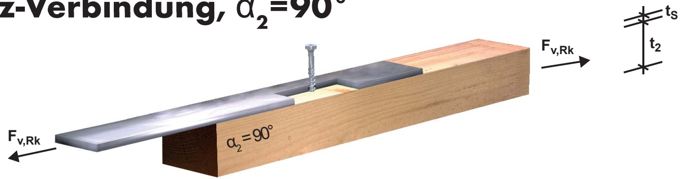
Schertragfähigkeit F_{v,Rk} und F_{v,Rd} mit erforderlicher Mindestschraubenlänge l_{req}
