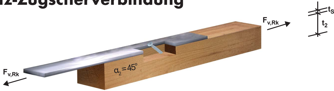
Schertragfähigkeit F_{v,Rk} und F_{v,Rd} mit erforderlicher Mindestschraubenlänge l_{req}
