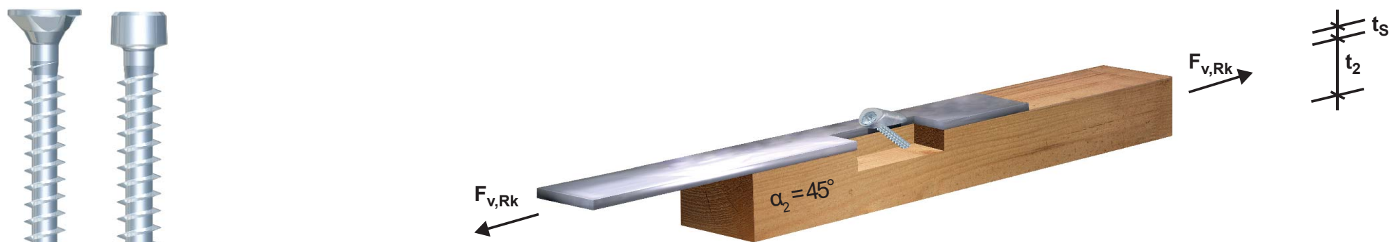
Schertragfähigkeit F_{v,Rk} und F_{v,Rd} mit erforderlicher Mindestschraubenlänge l_{req}
