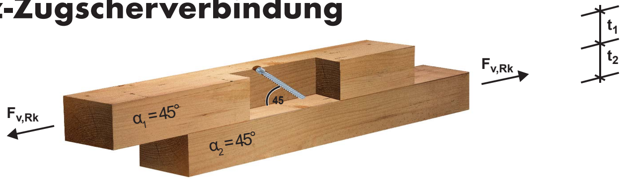
Schertragfähigkeit F_{v,Rk} und F_{v,Rd} mit erforderlicher Mindestschraubenlänge l_{req}
